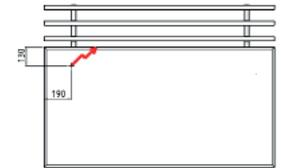
Prévoir arrivée électrique 400Vt+N+T (câble HO7RNF), 2 m de mou, protégée sur H=0.15m par gaine PVC rigide D32. Protégée au général par disjoncteur différentiel 30mA. A raccorder au bornier 6mm<sup>2</sup> du meuble.
