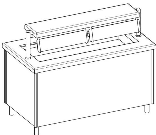
Arrivée d'eau automatique et trop plein 15/21 sur un coté, détecteur de niveau d'eau téflon de l'autre. Mise en route par interrupteur lumineux avec sécurité de chauffe.
