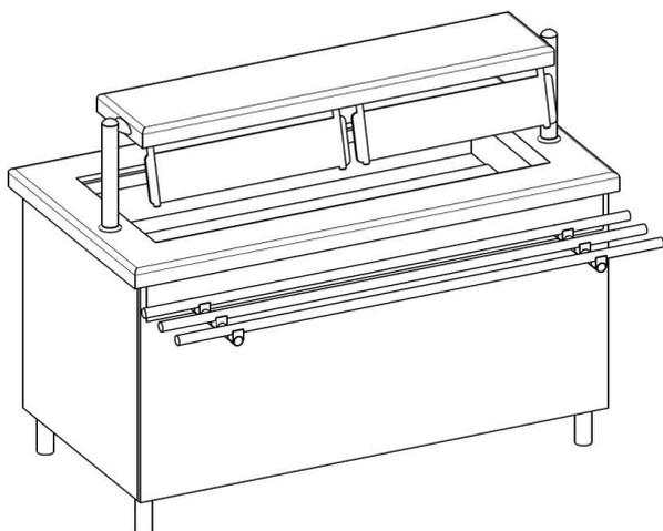
Assemblage des meubles par joint de 8 mm en base.
